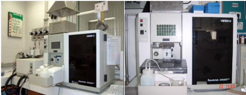
Figura 16. Fotografía del espectrofotómetro de absorción atómica Varian SpectrAA 220
