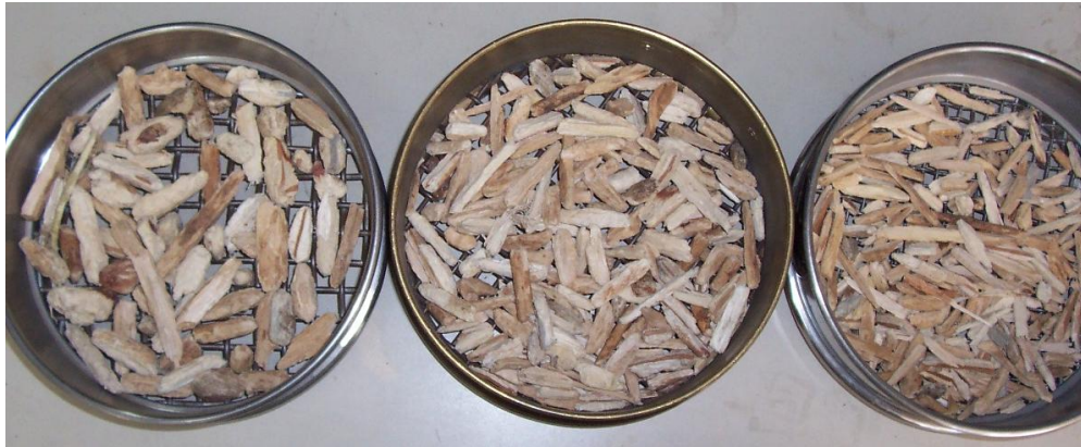
Figura 3.9. Material retenido en las mallas de \frac{1}{2} , \frac{3}{8} y de \frac{1}{4} pulg respectivamente
