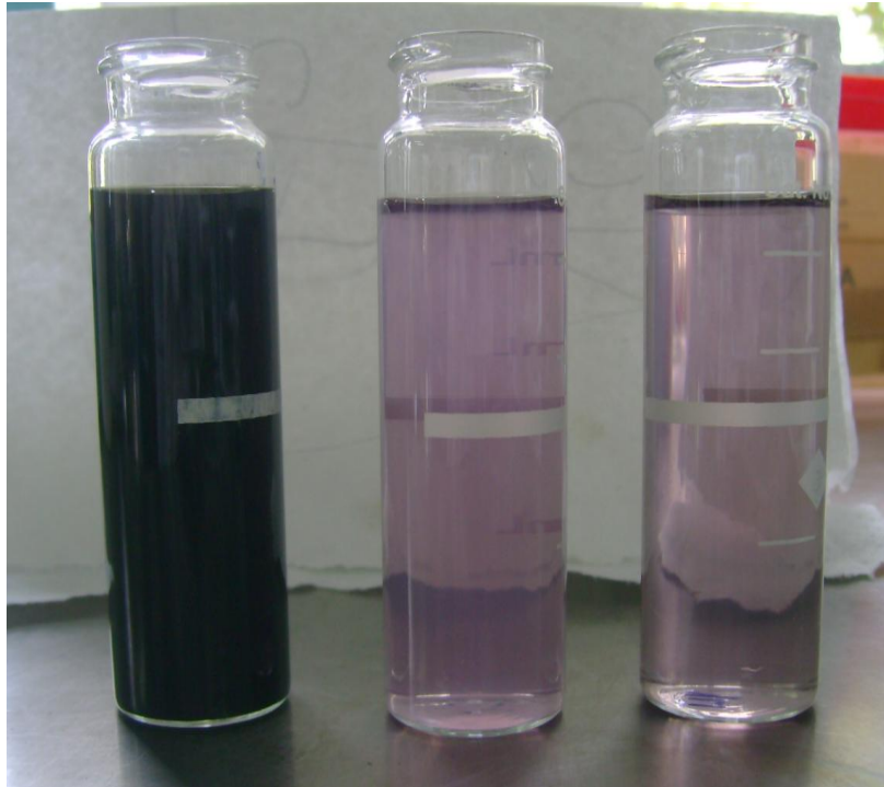
Figura A3.25. Color aparente en la fase 1 en el sistema de biofiltro anaerobio de lecho sumergido intermitente y SBR
