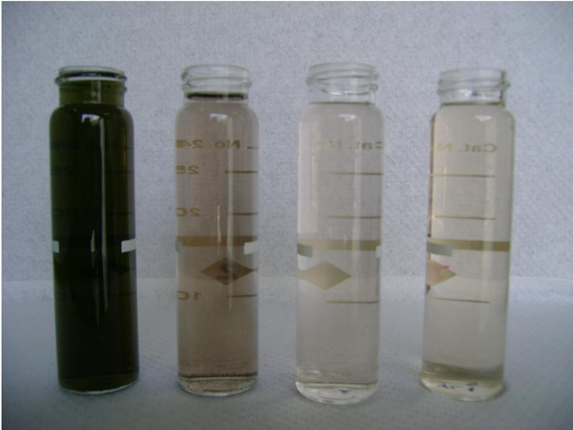
Figura A3.22. Color aparente en la fase 2 en el sistema de biofiltro percolador anaerobio en secuencia y humedal
