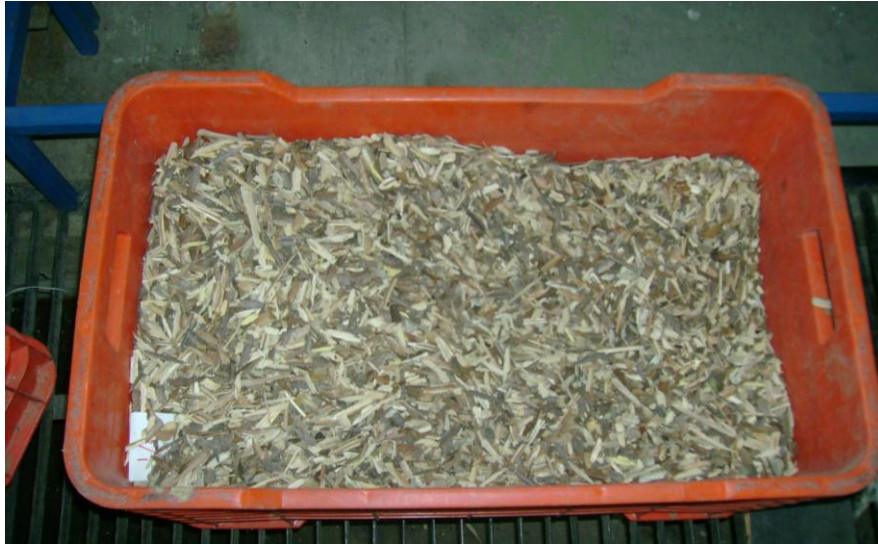
Figura 3.10. Material de empaque del biofiltro
