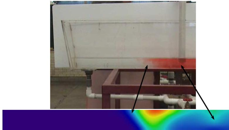
**Figura 4.15:** Distribución del colorante inyectado en el distribuidor después de 6 s
