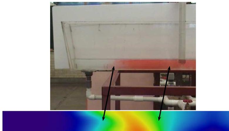
**Figura 4.16:** Distribución del colorante inyectado en el distribuidor después de 15 s
