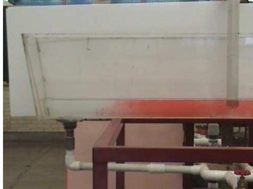
**Figura 4.4:** Distribución del colorante inyectado en el distribuidor después de 15 s
