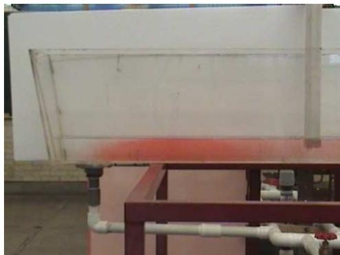
**Figura 4.5:** Distribución del colorante inyectado en el distribuidor después de 25 s
