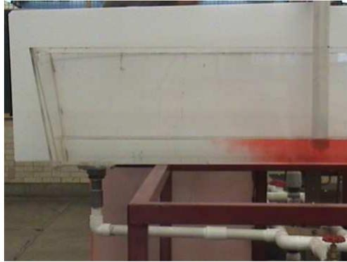
**Figura 4.3:** Distribución del colorante inyectado en el distribuidor después de 6 s
