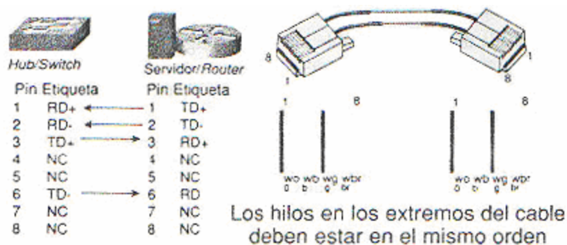
FIGURA 1.5 DIAGRAMA DE CABLE RECTO
