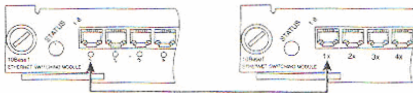
FIGURA 1.6 CONEXIÓN DE UN CABLE RECTO
