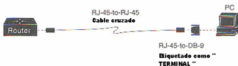
FIGURA 5.7 COMO CONECTAR EL CABLE DEL RUTEADOR AL PC PARA CONFIGURARLO.
