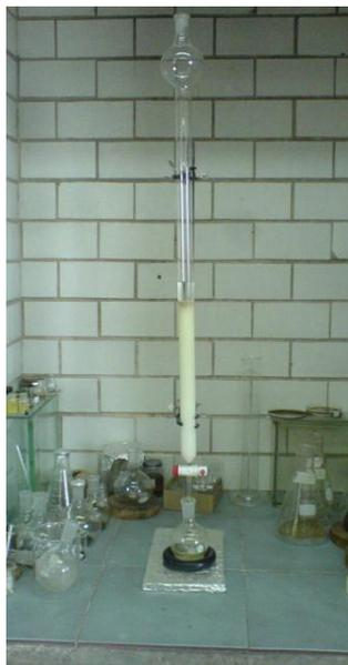
**Figura 9.** Columna de Sephadex LH-20 para el fraccionamiento del extracto acetónico
