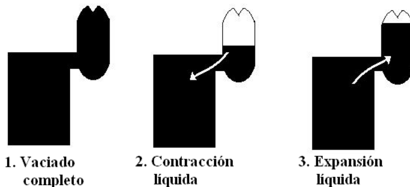
Fig. 1.7 Esquema representativo de una fundición aplicando el método de alimentación PCR.
