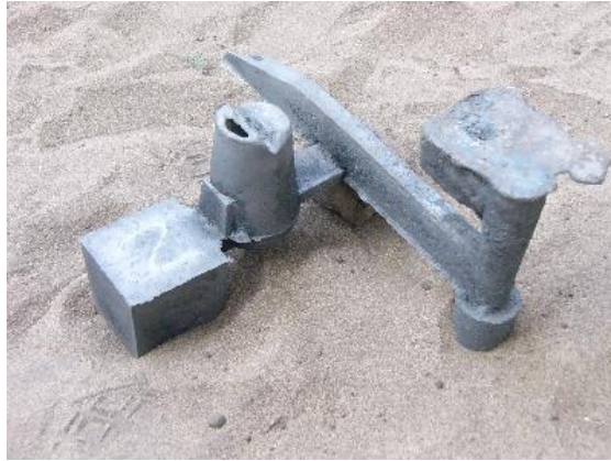
Fig. 4.1 Fotografía de la pieza obtenida con su alimentador y sistema de colada.
