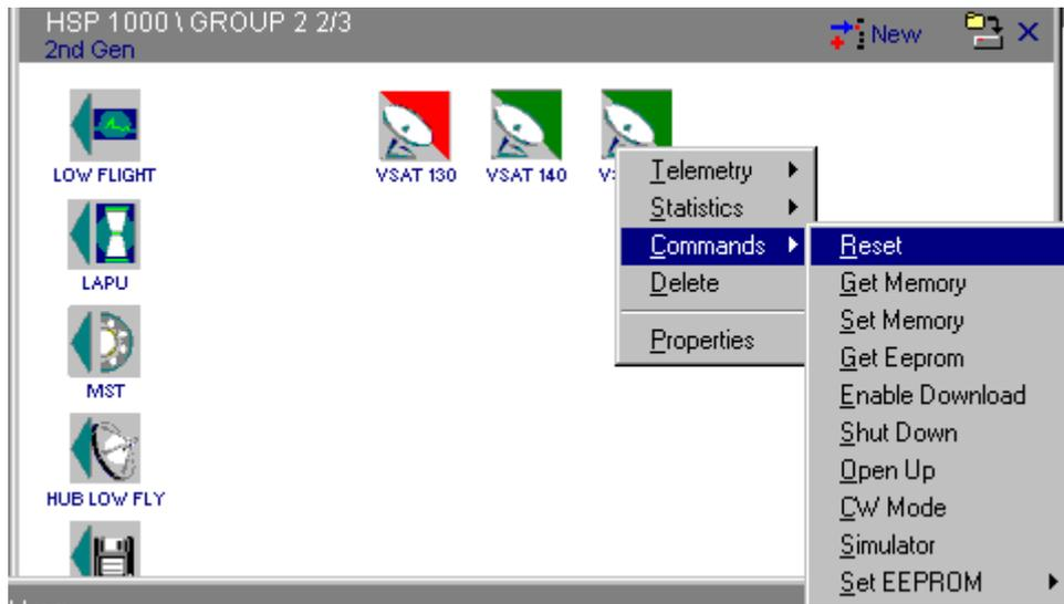
Figura 3.48. Reset de una VSAT
