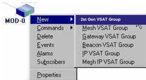
Figura 3.39. Acceso a la configuración de los grupos de VSAT .
