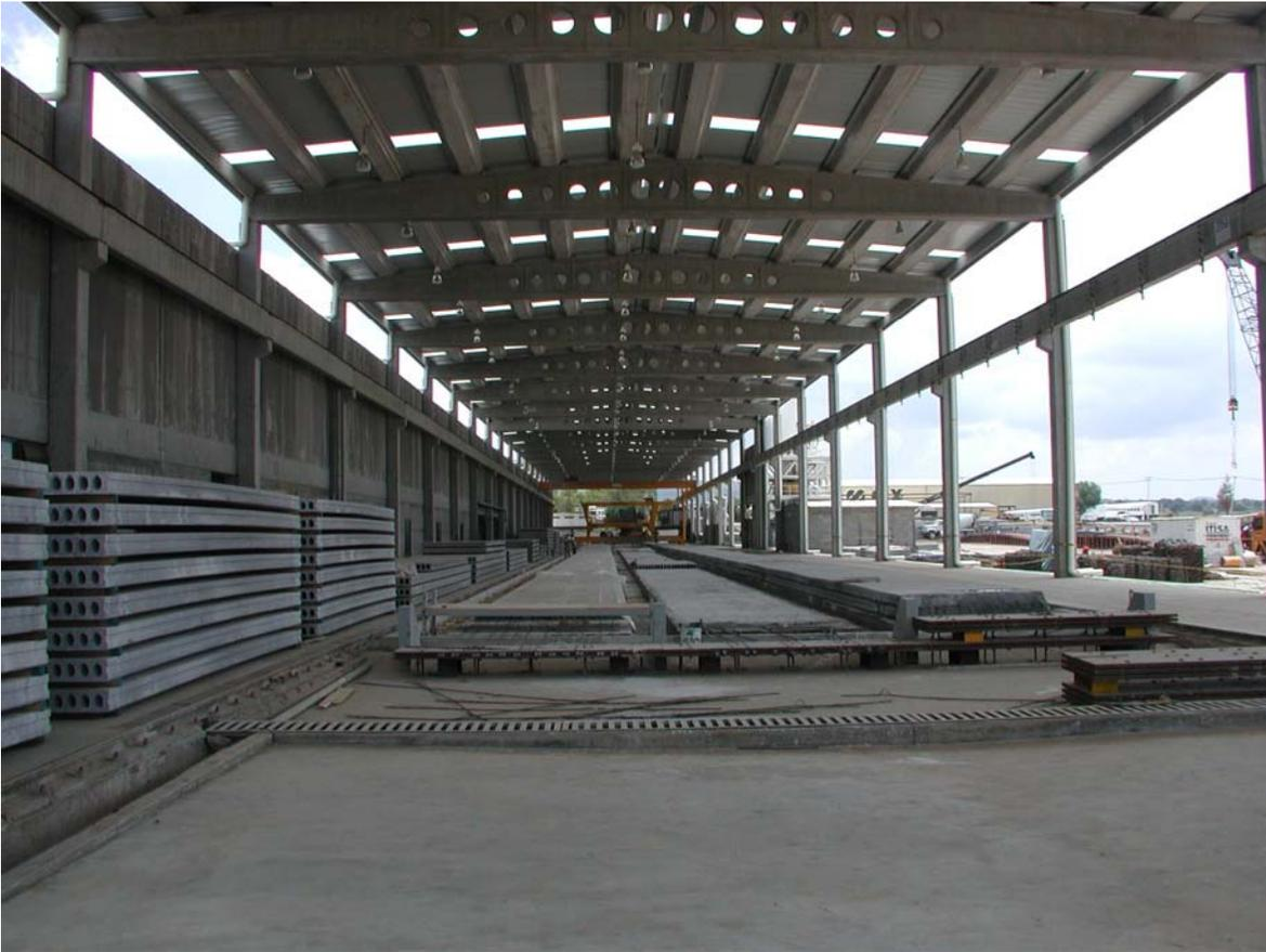
**Figura 3.1** Vista de la línea de producción de una planta prefabricadora de placas alveolares.
