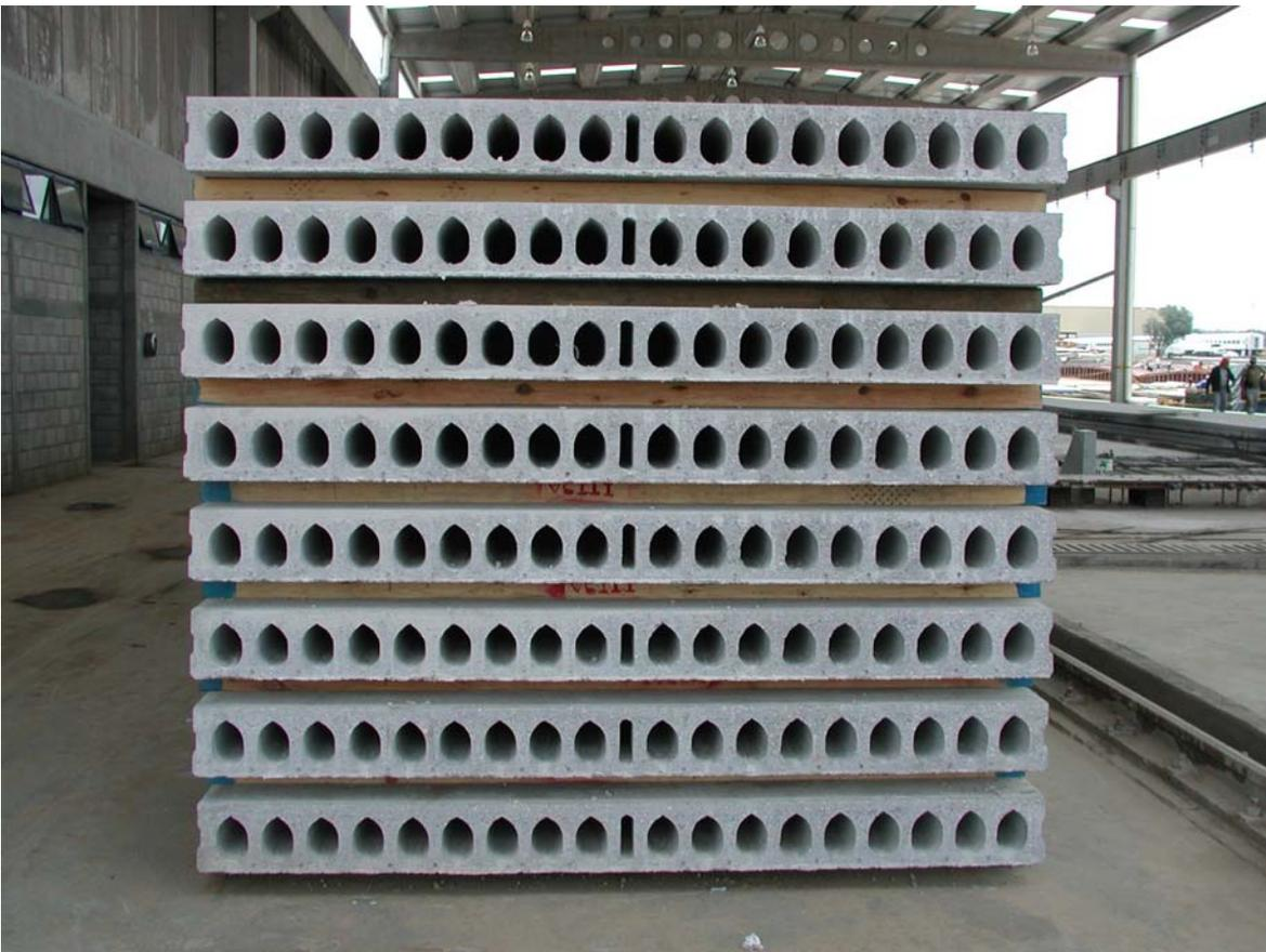
**Figura 6.1** Almacenaje de losas alveolares, evitando volados excesivos en los extremos.
