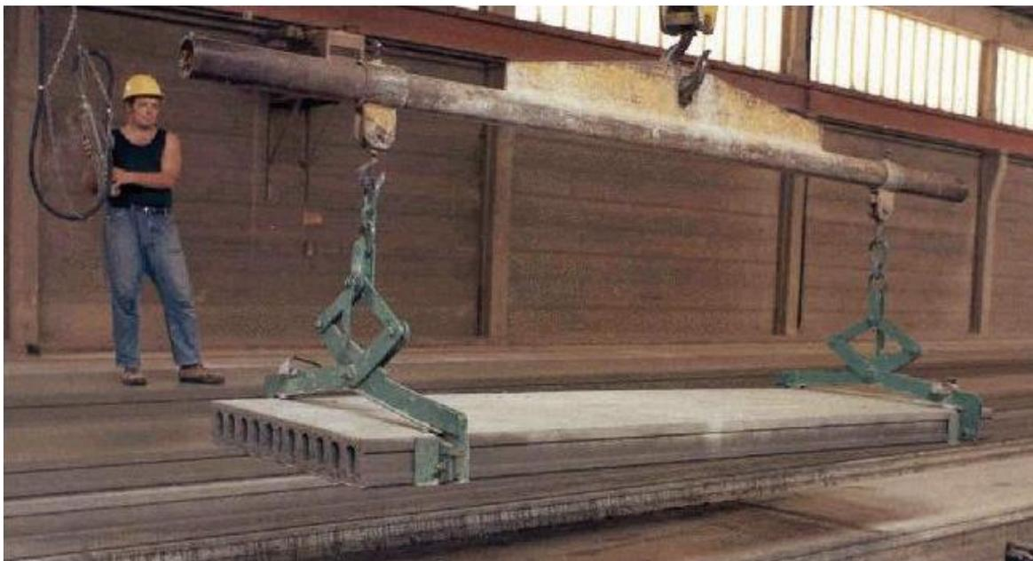
**Figura 6.2** Dispositivo para el izaje de las losas extruidas.
