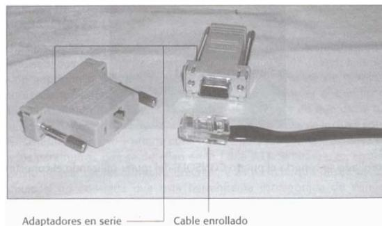
**Figura 3.5 Cable de conexión Router-PC**
