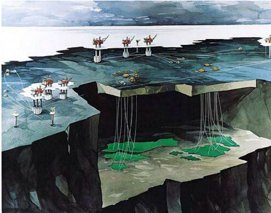
Figura 2-4: Ilustración del área de operación, con Tordis conectado a Gullfaks C a través de de dos tuberías de 11 km.
