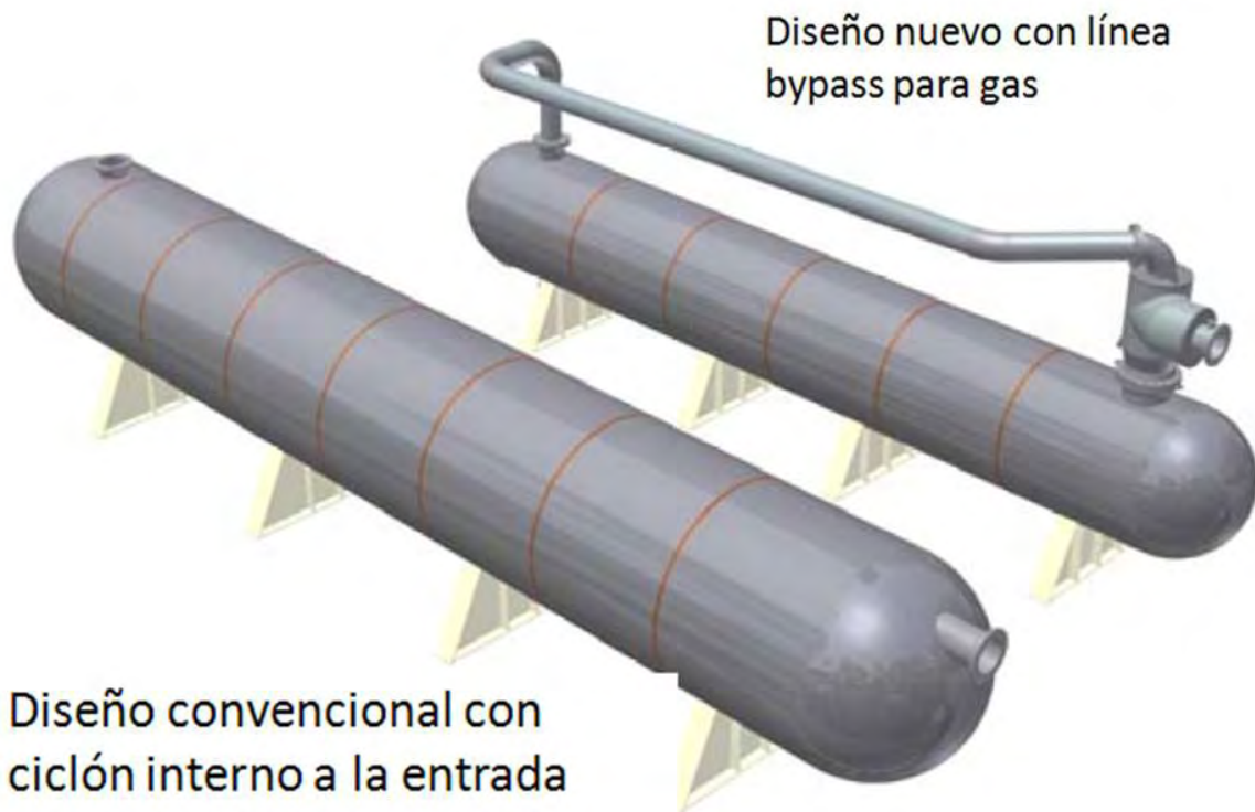
Figura 2-8: Ilustración que muestra la disminución del tamaño del separador cuando se le agrega la línea separada “bypass”, para conducir el gas separado por el separador ciclón a la entrada del separador submarino.
