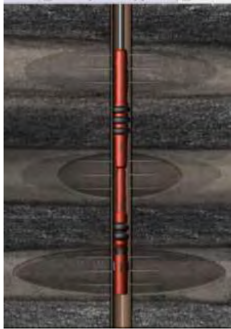
Fig. 3.29. Herramienta y proceso de RamStraddle
