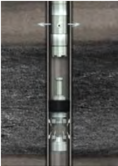
a) Se coloca empacador y se fractura
