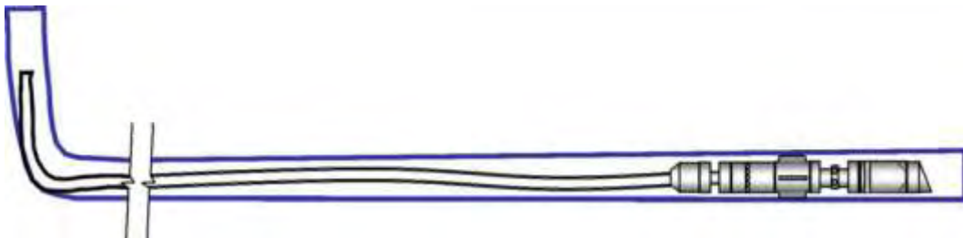
Fig. 3.9—La TF despliega la herramienta de chorro BHA en la ubicación de la primera etapa del fracturamiento, en sección lateral.
