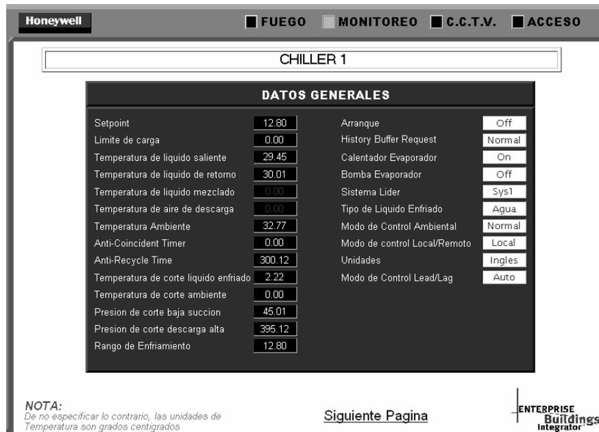
Fig. 2.10 Pantalla Típica de Parámetros obtenidos en Tiempo Real.
