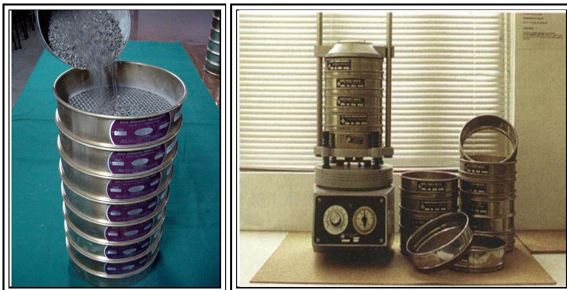
FIG. VI.1 Juego de mallas y equipo para determinar el tamaño de un sustentante.
