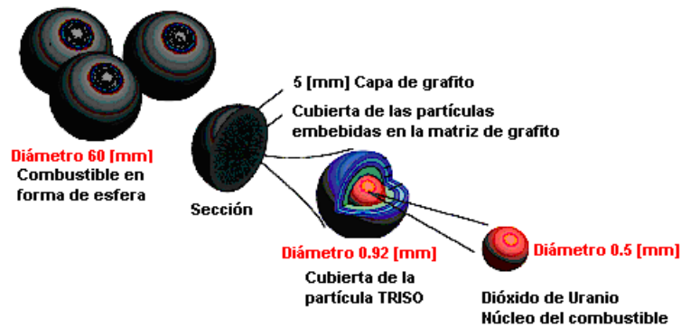
Figura 2.14 Combustible del reactor PBMR.
