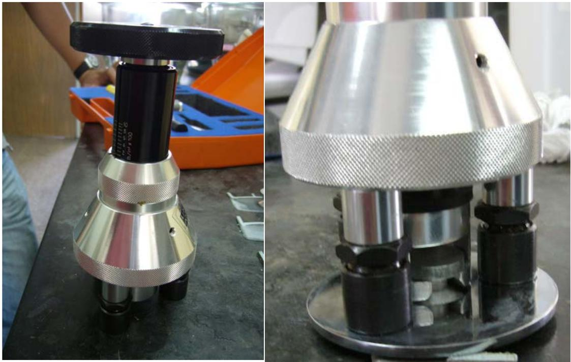
**Fig. 21. Aparato para la prueba de adherencia.**
