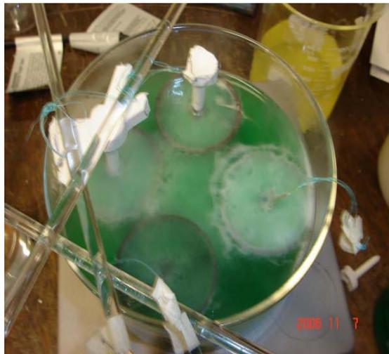
**Fig. 26. Niquelado químico** En la figura 26, se aprecia como interactúan las piezas de PBT con la solución de Niquelado químico donde se va creando la capa de niquelado químico bajo un control estricto de temperatura y pH.
