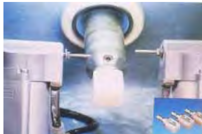
Figura 9. Bloque cerámico posicionado para fresado en la unidad Cerec In lab (sirona).
