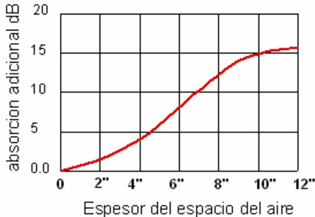
Fig. 21 Tabla para el cálculo de la absorción adicional en dB de acuerdo al espesor de la cámara de aire que se tiene. Aislamiento térmico y acústico de edificios. Autor: Royal Collage of Advanced Technology, Salford. Editorial Blume. Barcelona - España 1967
