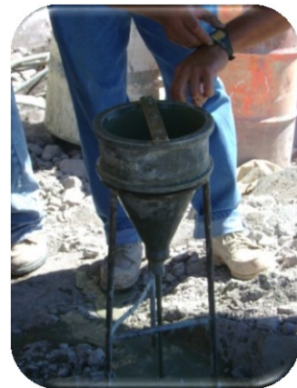
Foto III.4.2.1 Prueba de fluidez de mortero
