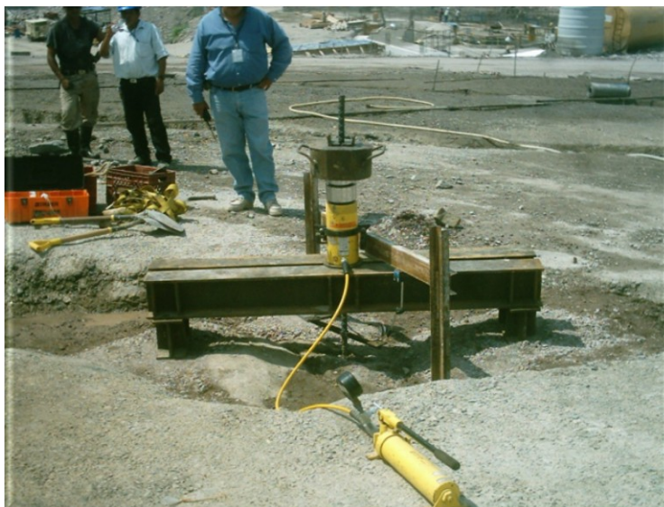
Foto IV.7.6 Dispositivo listo y dando precarga
