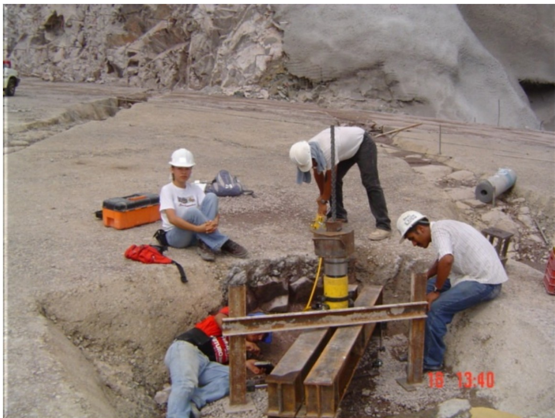
Foto IV.7.7 Dando carga y tomando lecturas de los desplazamientos del ancla
