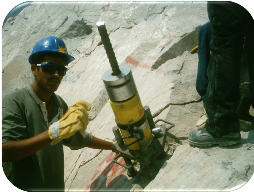
Foto IV.5.1 Acomodo de base (tripie) y gato hidráulico.
