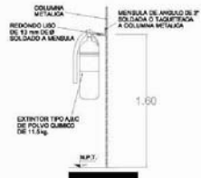
MONTAJE DE EXTINTOR
