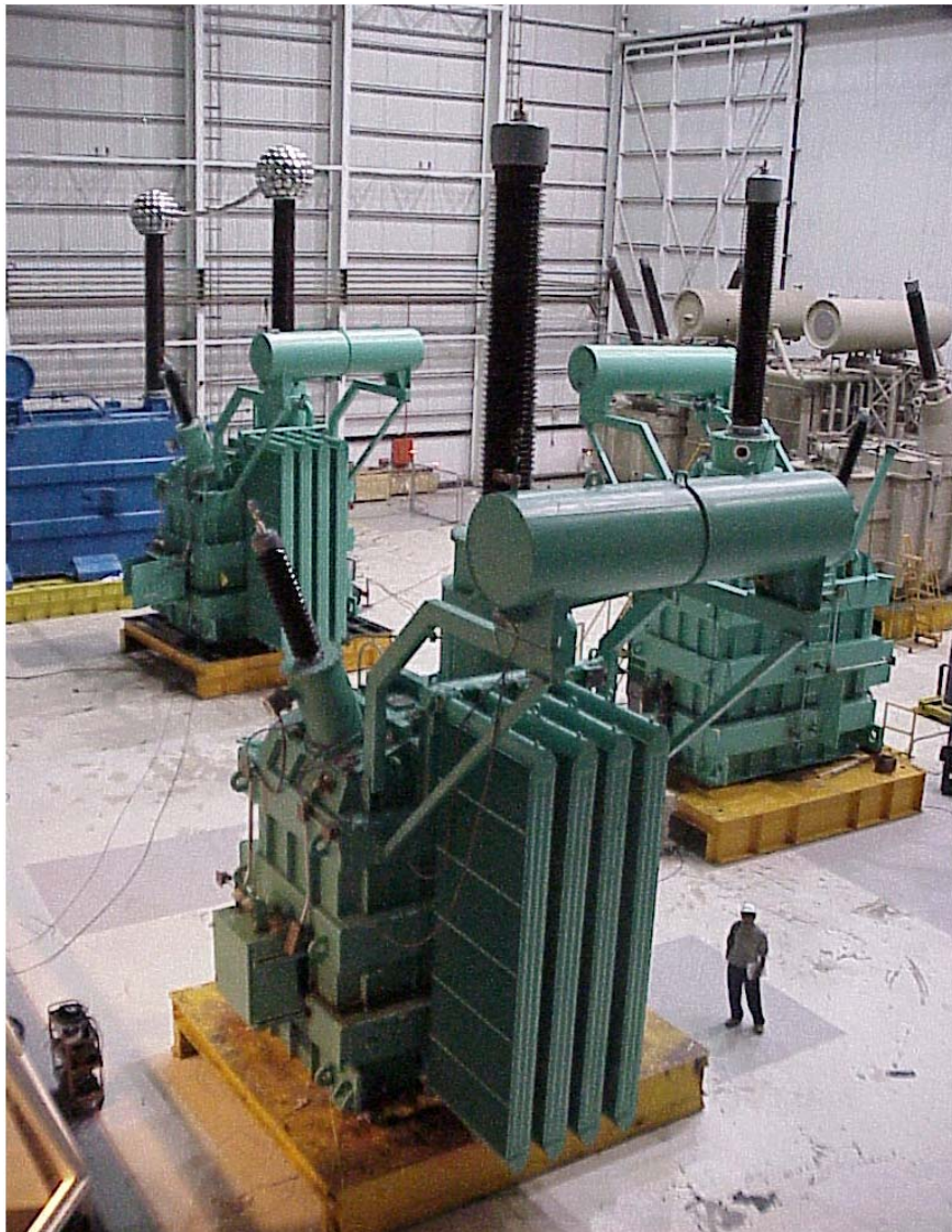
Figura 1.8.3.1: Banco de tres Reactores Monofásicos de 25 MVA, 400 KV.
