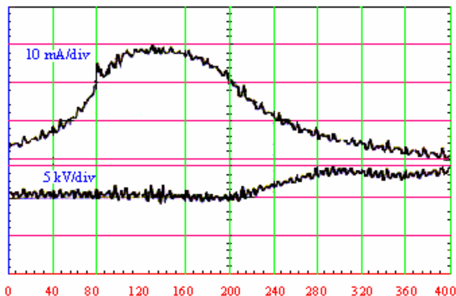
Fig. 3.5.2: Forma de onda típica de la corriente inducida por una DP lenta asociada a una fuerte degradación.
