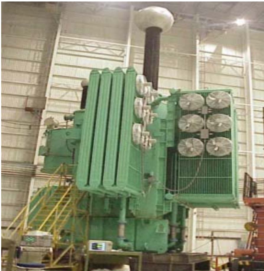
Figura 5.0: Transformador en el piso de pruebas.
