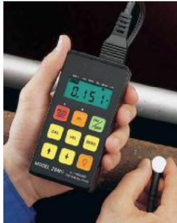
Figura No. 6: Instrumento ultrasónico.
