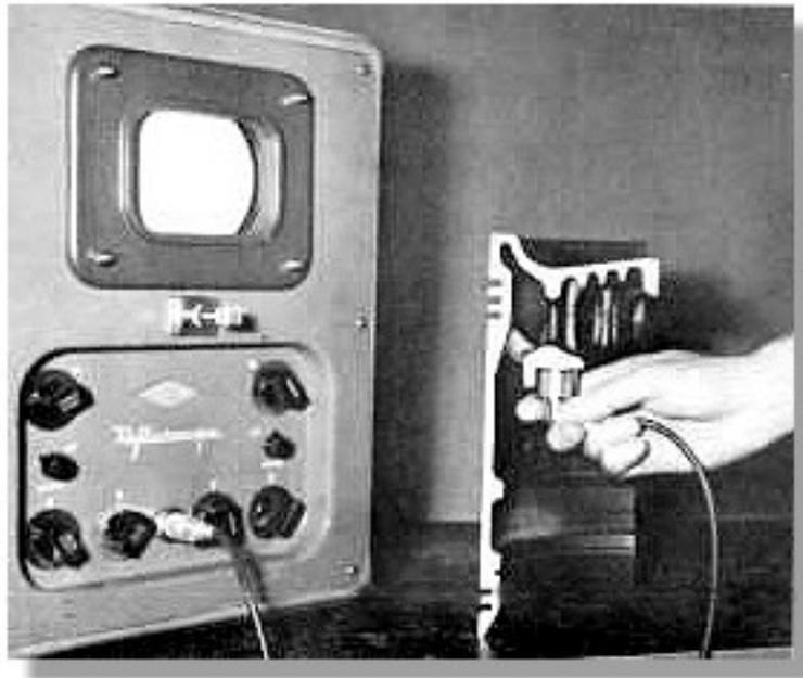
Figura No. 1: Reflectoscopio Supersónico de Firestone.
