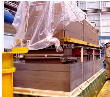
Figura 2-17. Núcleo de transformador tipo acorazado.
