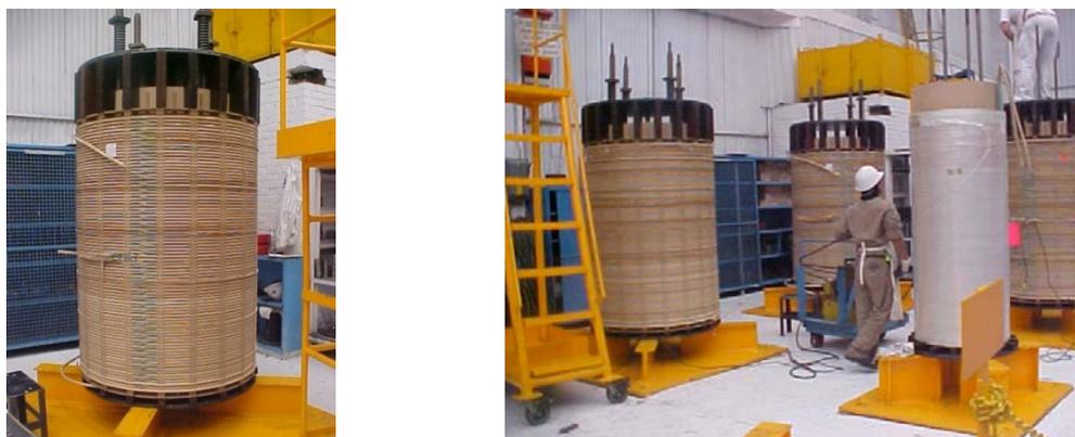
Figura 2-18. Devanados concéntricos de un Transformador de Potencia tipo columnas
