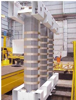
Figura 2-16. Núcleo trifásico de un transformador tipo columnas.
