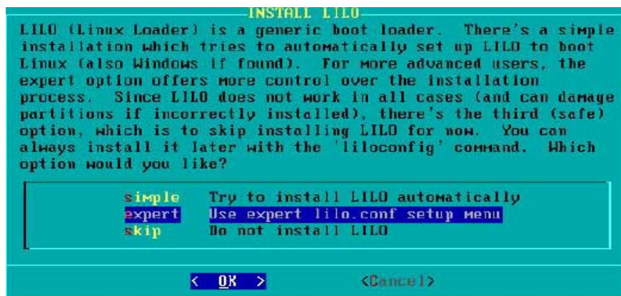
Fig.6 Ventana para instalar LILO
