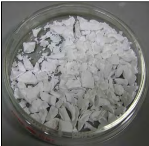
Figura 4.8 Hidrólisis de OCP. Después de secarlo, el resultado final a los diferentes tiempos de reacción es un polvo suave de color blanco.
