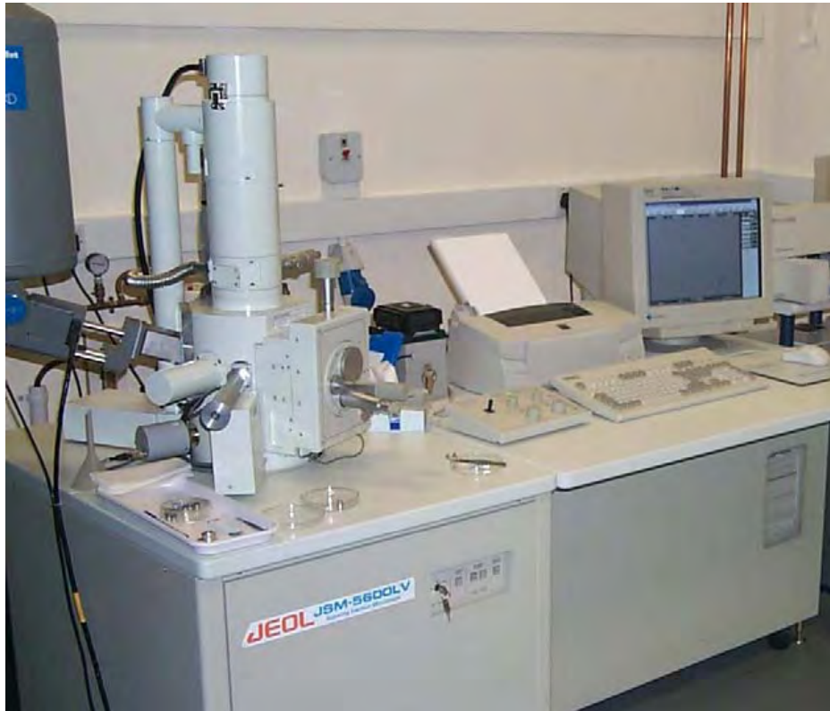
Figura 2.3 Microscopio electrónico de barrido modelo JEOL 5600-LV empleado en el análisis de muestras por MEB.
