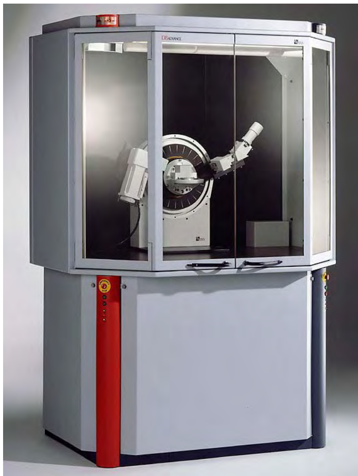
Figura 2.1 Difractómetro Bruker, modelo D8-Advanced, empleado en el análisis de muestras por difracción de rayos X.
