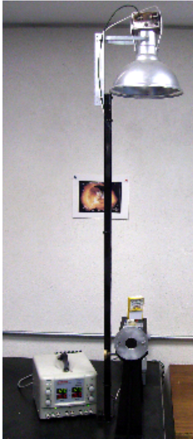
Figura 3.19. Arreglo que permitió llevar a cabo las pruebas de funcionamiento del sensor de sol.
