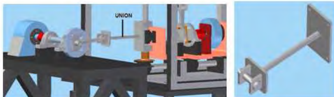
Fig. 2.45 Unión mecanismo biela-manivela y ejes verticales
