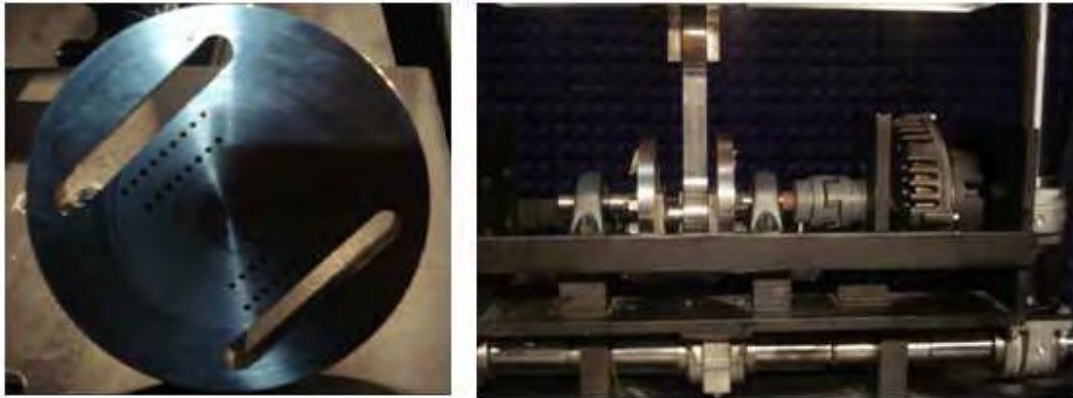
Fig. 3.10 Disco que hace las veces de manivela para el movimiento vertical
