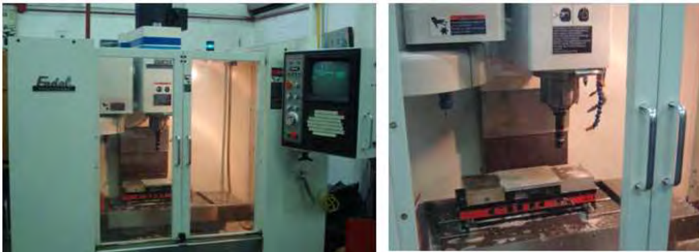
Fig. 3.7 Maquina CNC usada para hacer las bielas y el la manivela del movimiento vertical
