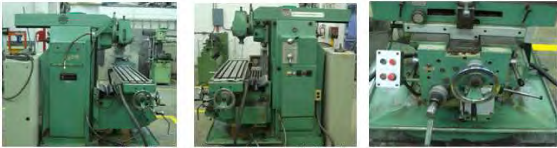
Fig. 3.6 Fresadora utilizada para la construcción de los elementos
