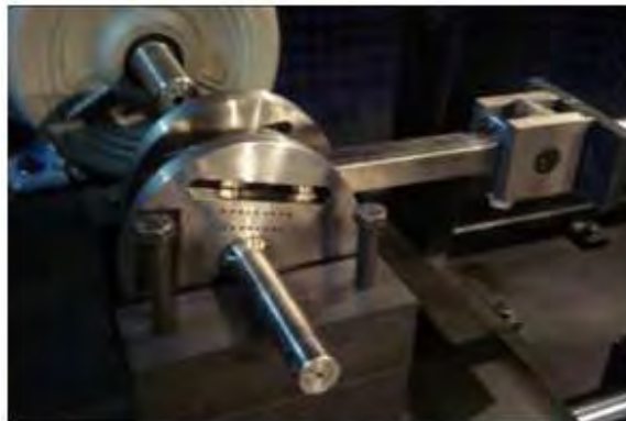
Fig. 3.11 Disco que hace las veces de manivela para el movimiento horizontal
