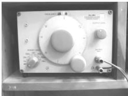
Figura 2.5 Generador de onda senoidal de frecuencia y amplitud variable.
