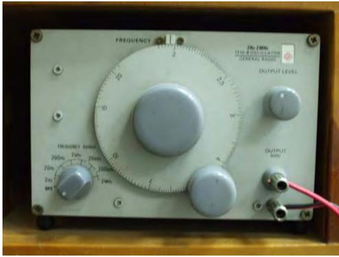
Figura 2. Generador de onda senoidal.
