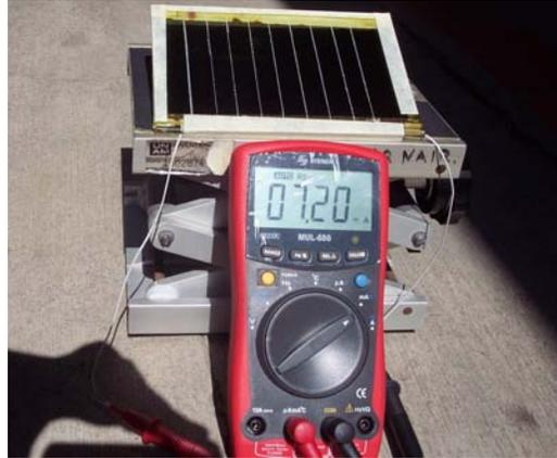
Figura 4.5: Corriente de corto circuito del prototipo de módulo fotovoltaico de  $10\text{ cm} \times 15\text{ cm}$  obtenido por la interconexión en serie de 10 celdas tipo CdS(cit)/Sb<sub>2</sub>S<sub>3</sub>(i)/PbS de  $7\text{ cm}^2$  de área cada una, medido bajo radiación solar global de  $1000\text{ W/m}^2$
