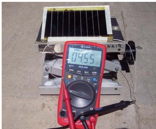
Figura 4.4: Voltaje de circuito abierto del prototipo de módulo fotovoltaico de 10 cm x 15 cm obtenido por la interconexión en serie de 10 celdas tipo:  $SnO_2:F/CdS(hex)/Sb_2S_3(i)/PbS$  medido bajo radiación solar de 1000 W/m<sup>2</sup>
