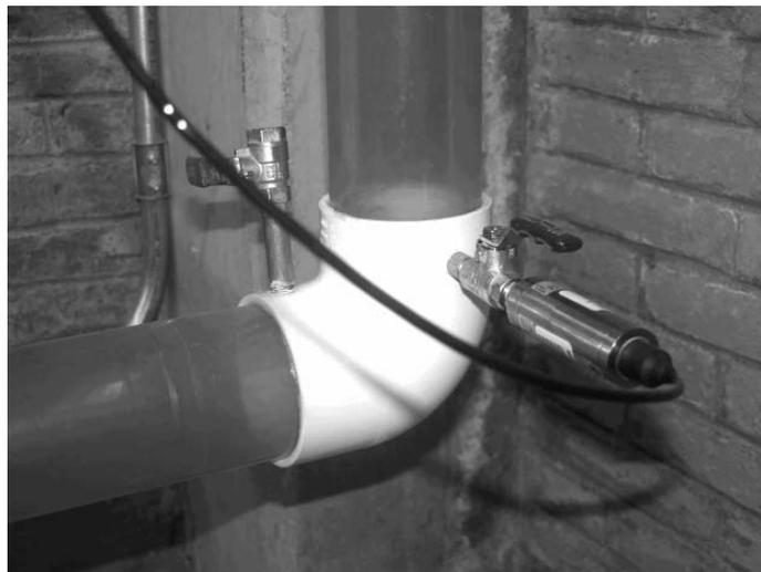
Figura 5.10. Transductores de presión (base del tramo vertical).
