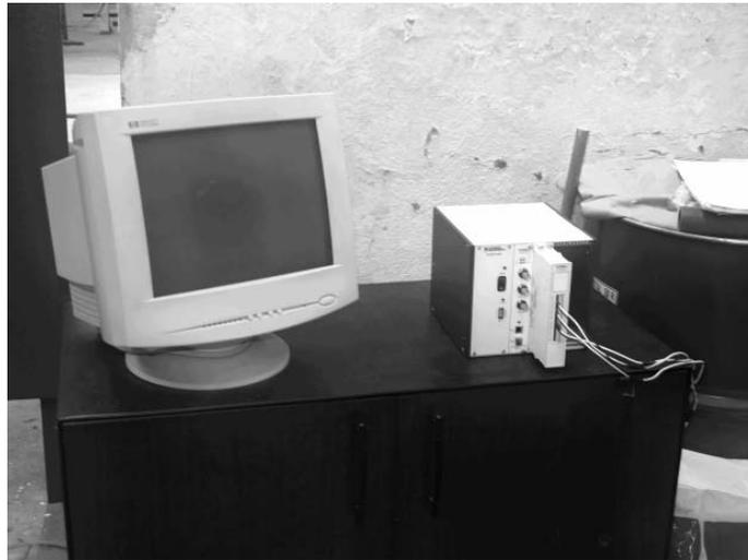
Figura 5.11. Equipo de adquisición de datos (NI-SCXI-1000).
