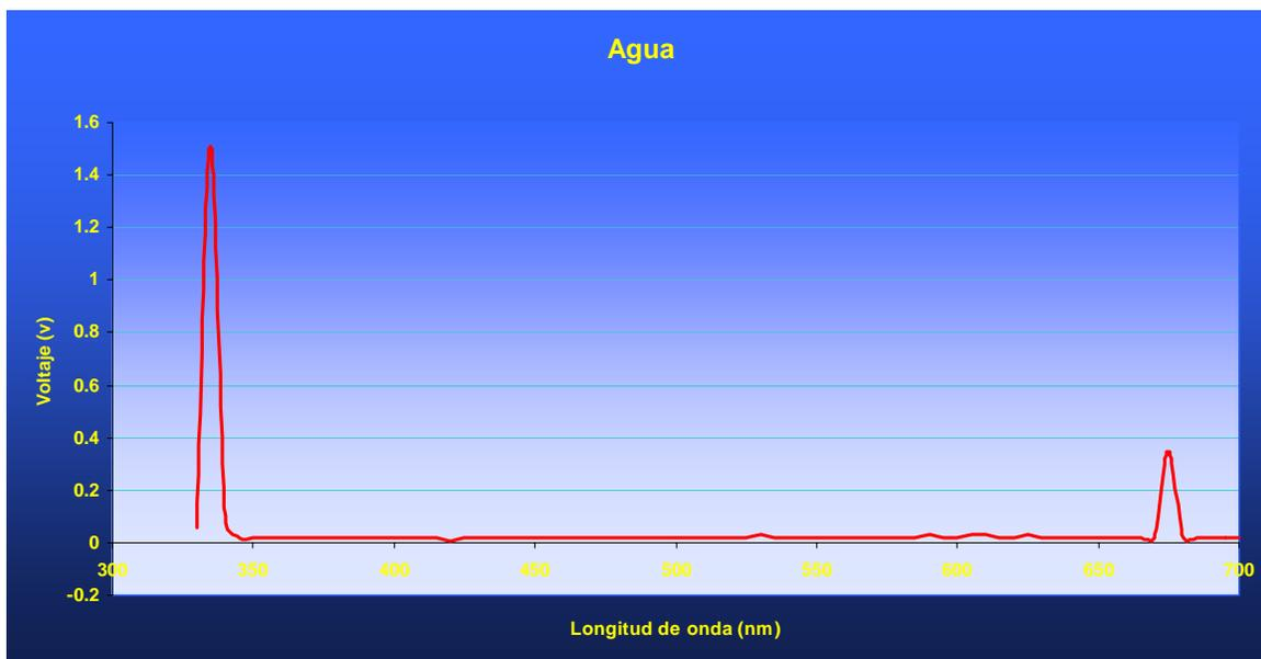
Fig. 3.3 Gráfica del análisis de emisión de fluorescencia del agua limpia.
