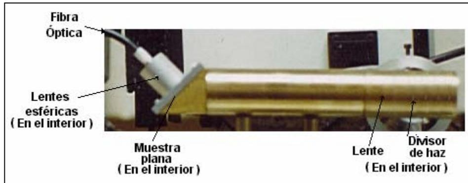
Figura 2.10 Cilindro donde se encuentran integrados el divisor de haz, la lente biconvexa y las esferas concentradoras de fluorescencia a la fibra óptica
