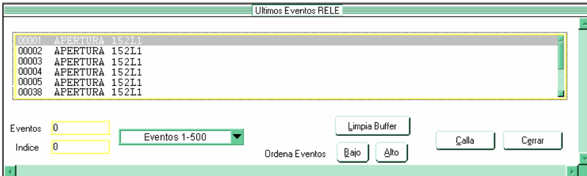
Figura 4.8.4 ventana de últimos eventos de apertura del interruptor 152L1.
