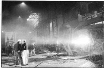
Horno eléctrico donde se funde la chatarra a 1,600° C para producir el acero.
