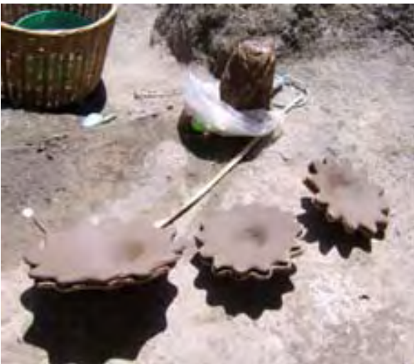
Piezas de soles recién extendidas en sus moldes y expuestas a los rayos del sol
