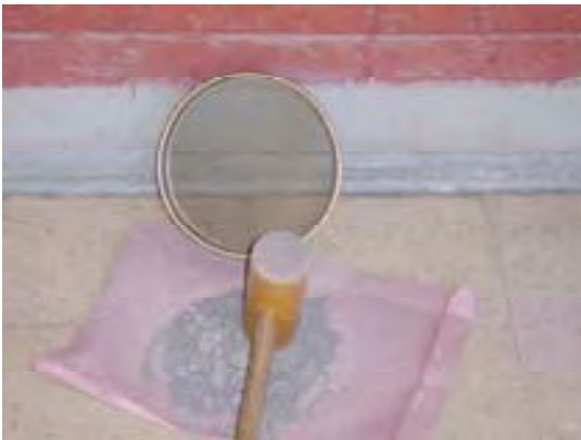
Tamiz malla No. 10 y mazo de madera para disgregar
