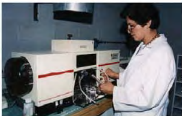
Determinación de cationes intercambiables por espectrofotometría de absorción atómica
