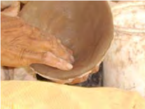
a) Tortilla de arcilla extendida con los dedos en un molde
