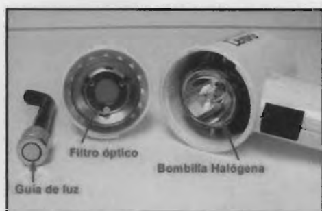
Fig.12 Bombilla halógena y filtro óptico para luz azul 3
