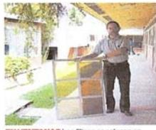
EN VENTANAS Los filtros se colocan en acetatos que se laminan entre dos vidrios
