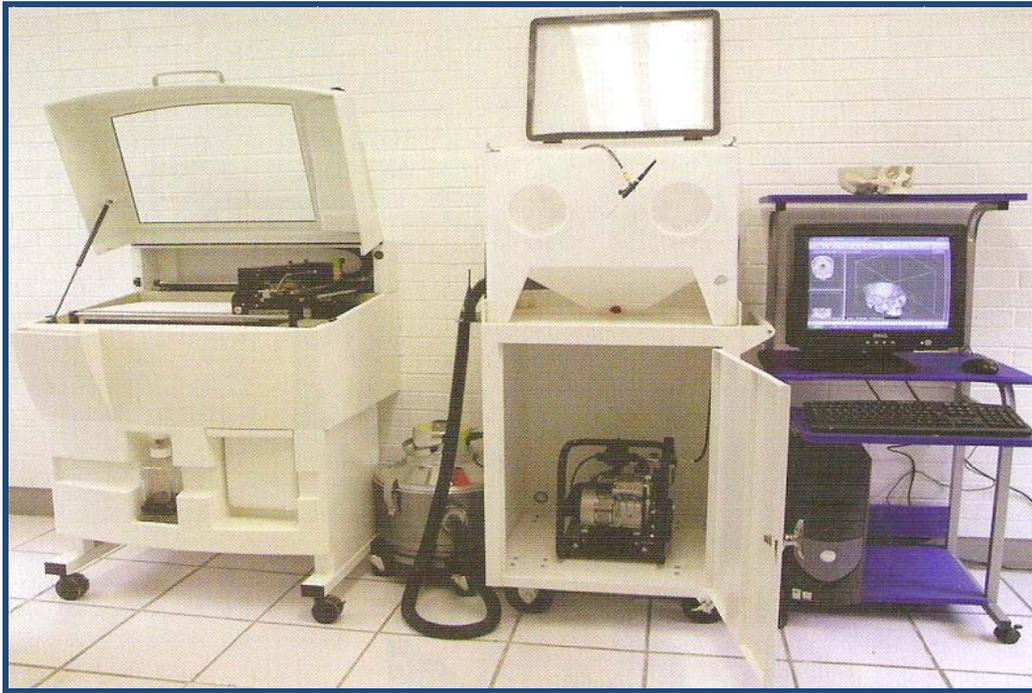
**Fig. 9** Estereolitógrafo<sup>2</sup>
