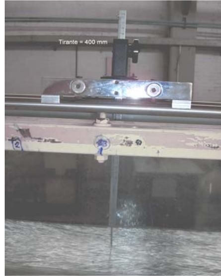
Figura 4.5 Acercamiento de la lectura del tirante por medio de un limnómetro
