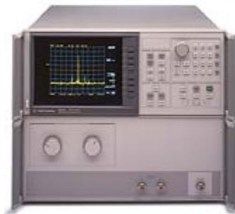
Figura 38. Equipo para mediciones de backreflection (refracción de retorno) en fibra óptica.
