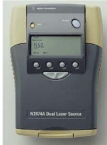
Figura 53. Generador laser Agilent Technologies
