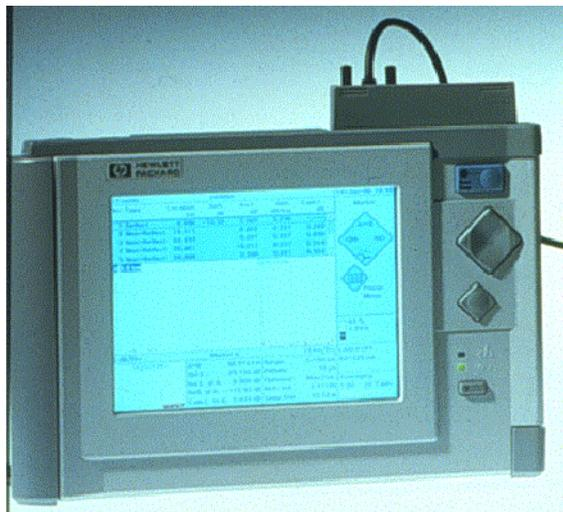
*Figura 48. Analizador OTDR HP*
