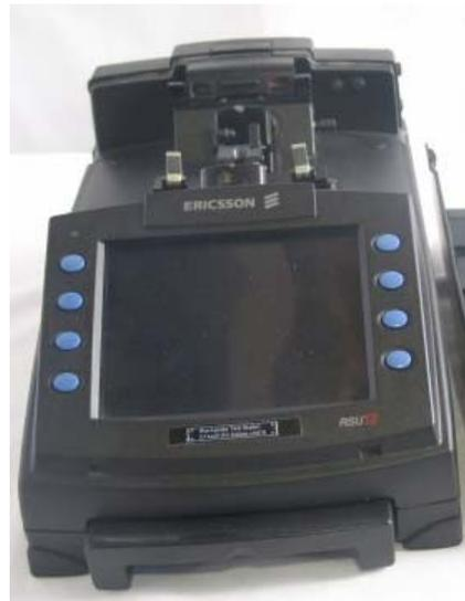
Figura 39. Equipo para empalme de fibra óptica automatizado.
