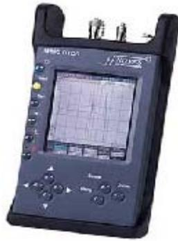
**Figura 35. Equipo para mediciones ópticas OTDR.**
