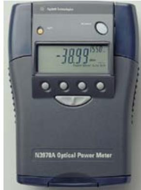
*Figura 54. Medidor de potencia óptica Agilent Technologies.*
