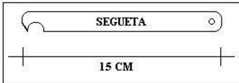
**Figura 4.1.** Esquema de un cortador para acrílico.
