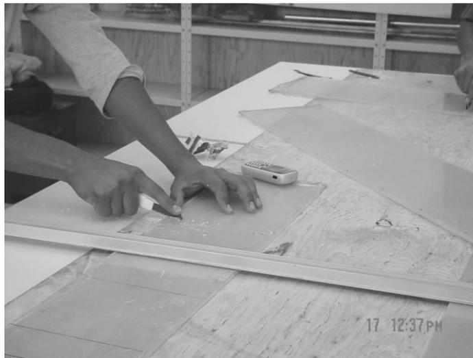
**Figura 4.2.** Cortado de placa de acrílico.
