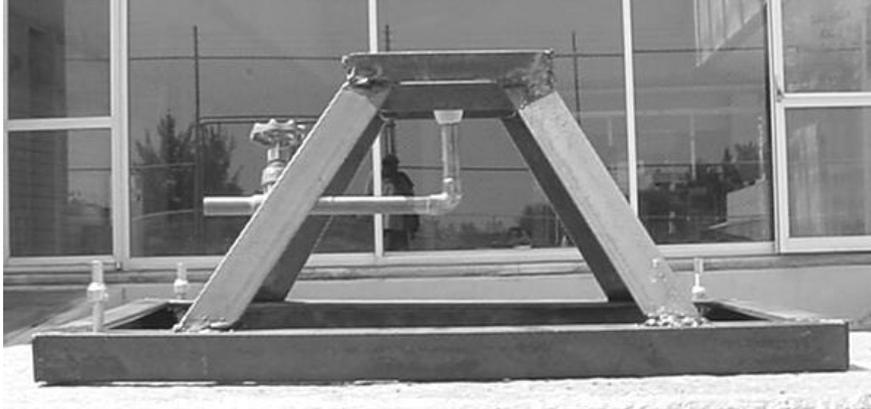
**Figura 4.5.** Base metálica con válvula de fondo.
