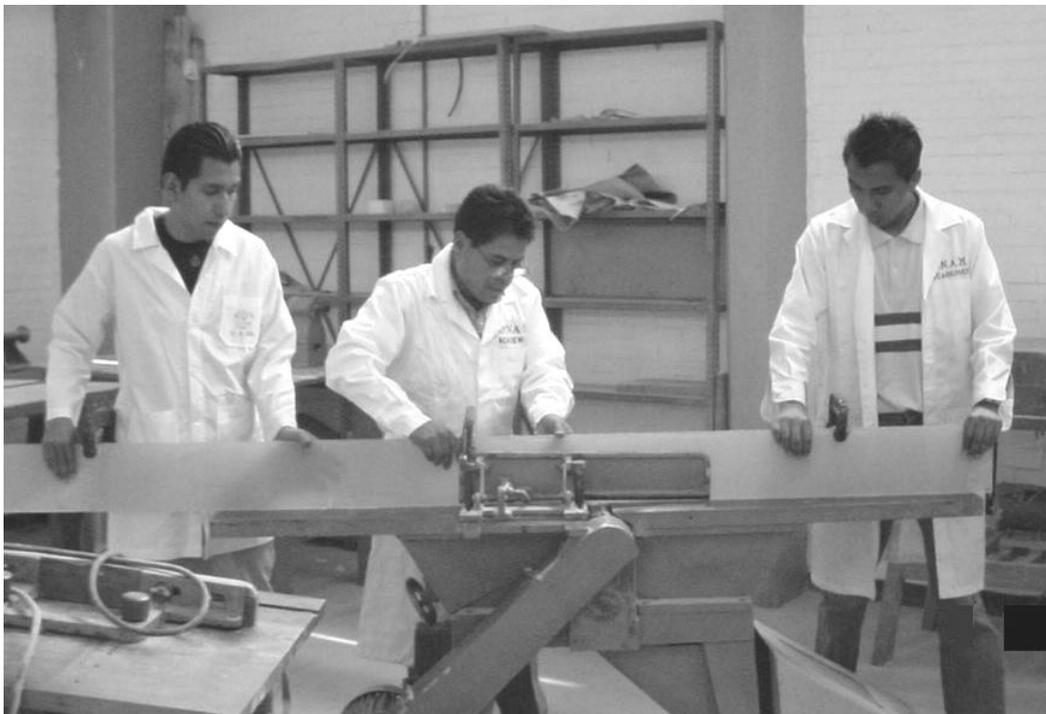
**Figura 4.3.** Canteado de acrílico para columna.
