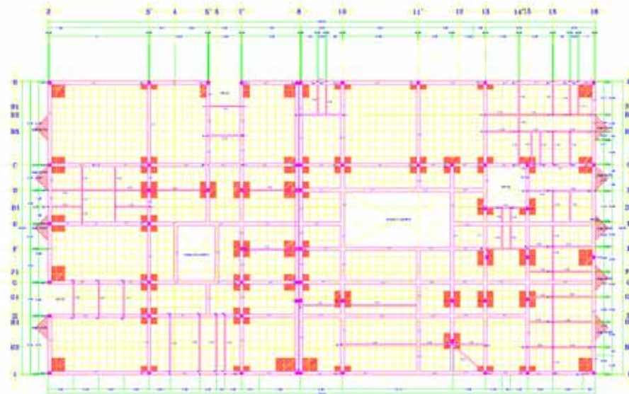
CUBIERTA DE CENDI (losa nervada)
