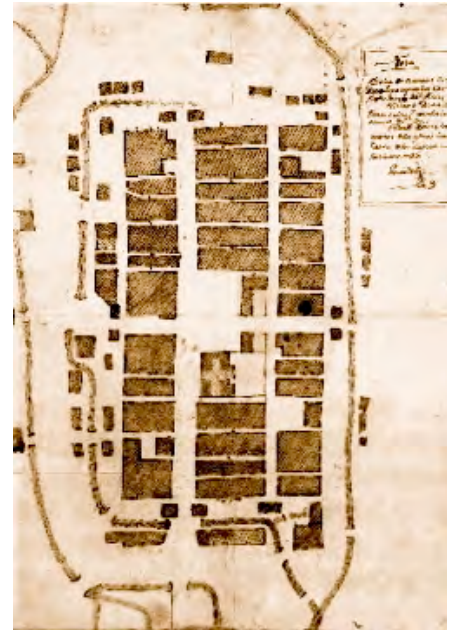
Plano de Santa Fe de Granada (1491), edificada a escuadra, casi rectangular, cruzada por dos calles principales y en la encrucijada de ambas una amplia plaza de armas. En los extremos de la cruz encontramos cuatro fuertes en los cuatro puntos cardinales, con cuatro puertas.
