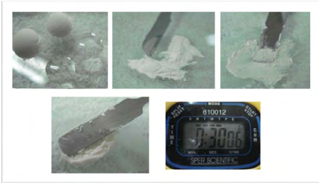
Figura 20. Método de mezclado de Ketac™ Molar Easymix
