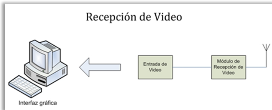
Figura 6.10 Diagrama de bloques de los módulos de la recepción de imagen del video
