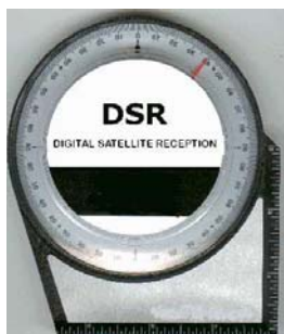
Figura 3.11 Inclinómetro utilizado en la orientación de antenas
