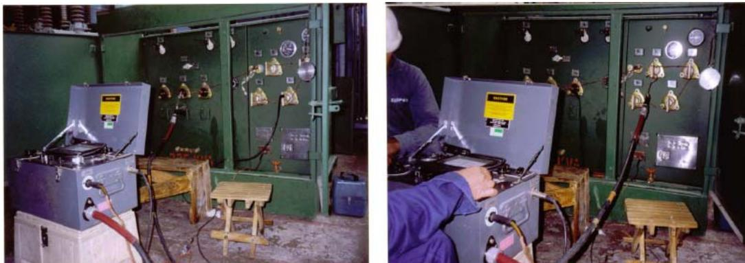
FIGURA 10.- Equipo de prueba para factor de potencia
