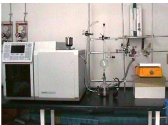
FIGURA III-18.- Cromatógrafo detector de gases disueltos en el aceite.
