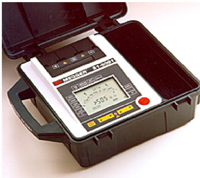
FIGURA III-1.- Equipo de medición de resistencia de aislamiento “MEGGER”.
