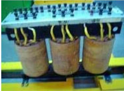
FIGURA 3.- Núcleo de columnas
