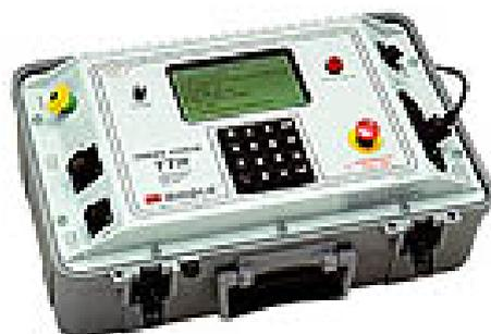
**FIGURA 3.-** Equipo de medición empleado para medir la relación de transformación de transformadores de potencia y distribución.
