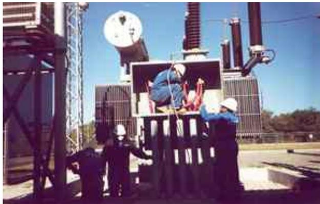
**FIGURA 2.-** En esta figura se muestra al personal de la empresa encargada de realizar las pruebas al transformador preparando al transformador para la prueba de resistencia de aislamiento.
