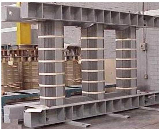
FIGURA 4.- Construcción del núcleo de un transformador de potencia.
