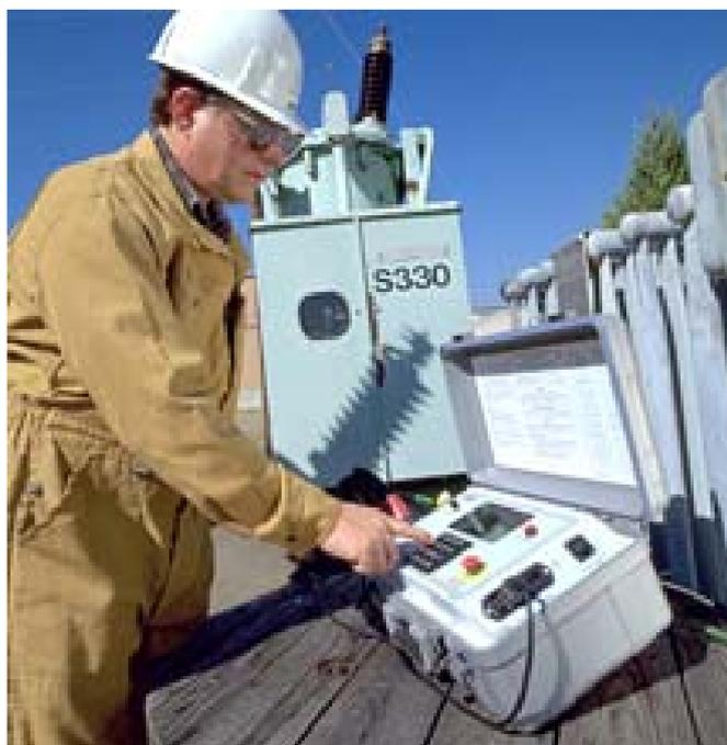
**FIGURA 4.-** Medición de la relación de transformación de un transformador.
