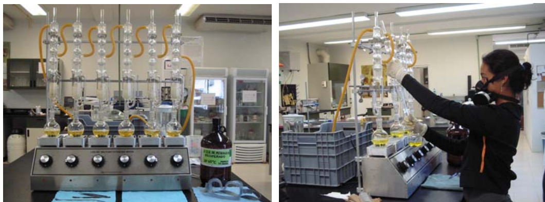
Fig. 10. a) Dispositivo de extracción de grasas “Soxhlet”; b) Recuperación del éter usado durante el proceso de desengrasado.
