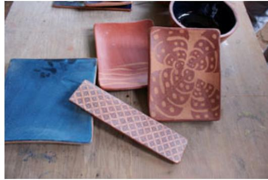
La técnica que utiliza este taller es de moldes rústicos, hechos de cartón o con piezas ya cocidas (sancochadas); es la manera en que puede sacar una gran producción rápidamente; a las que no le va a dar el acabado con un esmalte industrial libre de plomo, las decora con un engobe preparado con óxido de hierro rojo, negro, manganeso, cadmio o de tierras locales, las esgrafía sobre el engobe bruñido y sólo las quema una vez.
