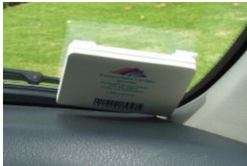
Fig. 5.1 Una etiqueta RFID empleada para la recaudación de peaje electrónico
