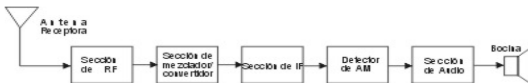
Fig. 2.9 Diagrama básico de un receptor AM
