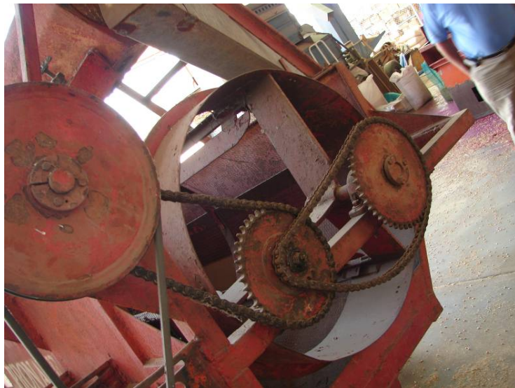
Figura 2.2 Disposición de los engranes de una máquina rotatoria
