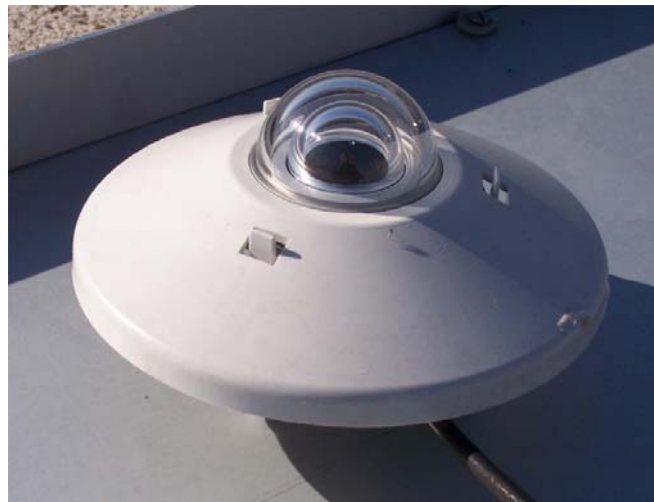
Piranómetro, instrumento de medición que se usa para evaluar el recurso solar con el que se cuenta día y noche.
